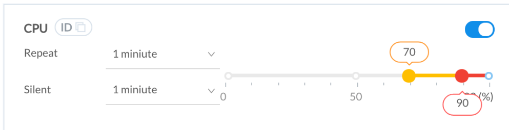
Figure 12. CPU 사용율이 70%를 넘는 경우 Warn, 90%를 넘는 경우 Fatal 이벤트를 발생시킵니다.
